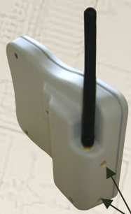
Recharge sur support par 2 contacts
